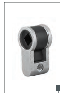
Accessoire disponible : adaptateur à condamnation carré 6 mm pour serrure à encastrer. Il permet de transformer une serrure à cylindre européen en une serrure bec-de-cane à condamnation.
